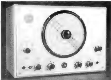
UKW- und Fernseh-Prüfender Videotest (Nordfunk). Frequenzbereich 5...250 MHz, Zf-Bereiche gespreizt. Bildmodulation durch Balkenmuster
